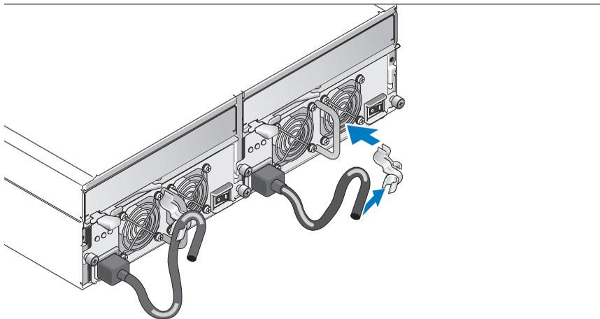
전원 케이블의 반대쪽 끝을 접지된 전원이나 UPS (Uninterruptible Power Supply) 또는 PDU (Power Distribution Unit)와 같은 별도의 전원에 연결합니다.
