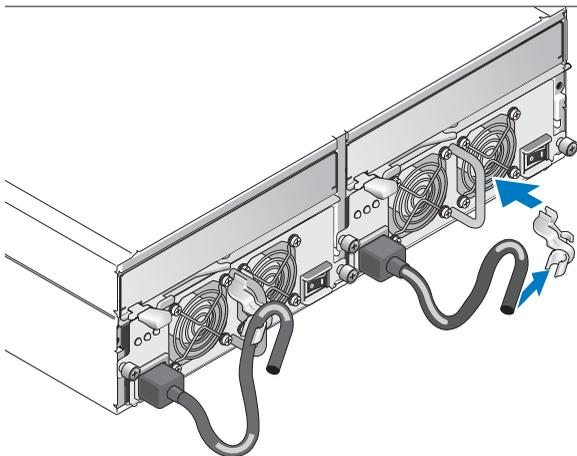
将电源线的另一端插入接地的电源插座或一个单独的电源（如不间断电源设备 [UPS] 或配电装置 [PDU]）。
